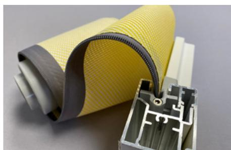
Principe du système ZIP : un ruban cranté est soudé sur les côtés de la toile sur toute sa hauteur. Cette dernière, guidée dans une contre-coulisse en PVC, sera retenue dans les coulisses aluminium du store. Cette technique permet à votre store DÉCOZIP de résister à des vents supérieurs à force 9 (75 à 88Km/h). Notre **DÉCOZIP 105** a obtenu la classe 5 sur 6 à la norme EN13561 (Exigences de performance y compris la sécurité - tests menés au CSTB de ST Martin d'Hères avril 2017).
